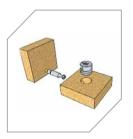
Existem no mercado diferentes produtos para fixação e montagem como os com bucha e os que são aparafusados diretamente na peça. O uso de parafusos no topo da peça não deve ser superior a 1/3 da espessura do produto.
